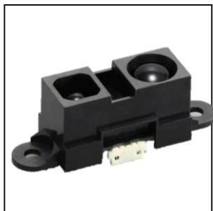
ORD1L31C-xxxは、赤外LEDと2ch PDを組み合わせた三角測量方式の赤外線測距センサです。一定の距離で出力が切り替わるデジタル出力タイプで、人や物体までの距離を検出する用途に最適です。ROMから調整値を読み出し、書き替えることで複数の検出距離に対応可能です。
