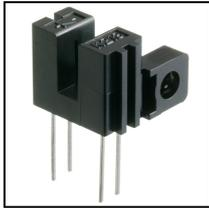
SG213は、高出力赤外発光ダイオードと高感度フォトランジスタを組合わせた透過型フォトインタラプタです。高精度位置検出に適した汎用インタラプタです。
