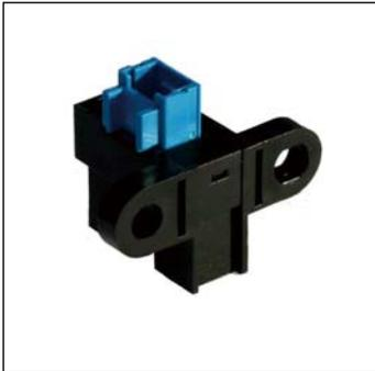
LG2A17D4は、高出力赤外発光ダイオードとフォトICを組み合わせた透過型フォトインタラプタです。高精度位置検出に適し、高機能、高信頼性の物体検出システムの構成が容易です。
