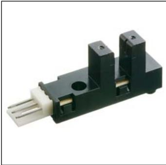
LG217L□、LG217D□は、高出力赤外発光ダイオードとフォトICを組み合わせた透過型フォトインタラプタです。高精度位置検出に適し、高機能、高信頼性の物体検出システムの構成が容易です。
