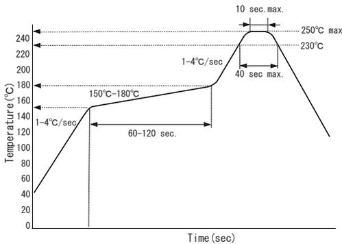
1. 左グラフに示したリフロー条件内であっても、基板の反り・曲がり等によりパッケージに応力が加わった場合、パッケージ内部の金線断線を誘発する恐れがありますので、ご使用になられるリフロー装置において十分製造条件を確認の上、ご使用下さい。
