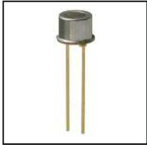
BL15-1212Hは、当社独自のLEDプロセス技術により発光点での電流密度を高めた4元素AlGaInP、発光波長650nmのLEDです。発光面にボールレンズを実装することで狭指向性を実現しました。
