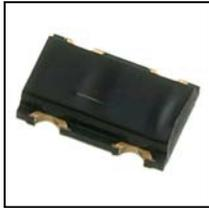
PIC79603は、超小型の面実装の光リモコン・モジュールです。形状は極小の4.5x2.8x1.1mmです。3Vから5Vまでの駆動電圧に適用し、消費電流は0.9mAと低消費です。マルチボルテージ・タイプですので、ご採用機器の電源電圧を選びません。
