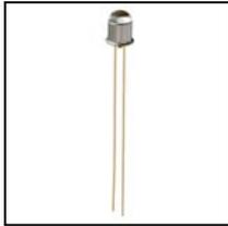
CL-1KL3は、メタルキャップをハーメチックシーリングした、TO-18タイプの高出力GaAlAs赤外発光ダイオードです。発光出力は、GaAsタイプに比べて高くなっています。
