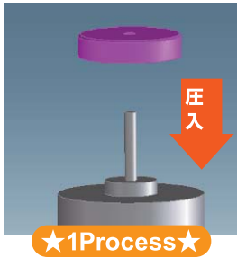
Cup disk+エンコーダ組み立て工程/ モーター取り付け例
